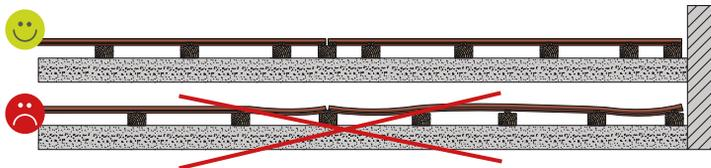
Chaque extrémité de lame doit avoir 2 lambourdes espacées d'un entraxe de 200 mm maxi. Pour la fixation des lames, voir page 10.
