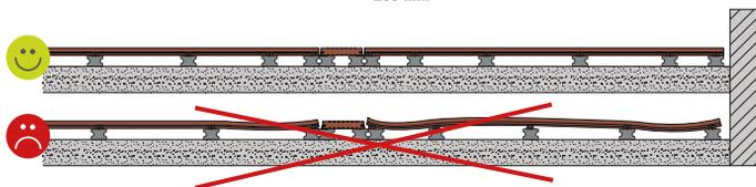
Chaque extrémité de lame doit avoir 2 lambourdes espacées d'un entraxe de 200 mm maxi. Pour la fixation de la lame intermédiaire perpendiculaire, voir page 12.
