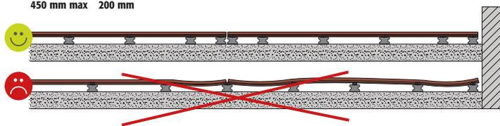
Chaque extrémité de lame doit avoir 2 lambourdes espacées d'un entraxe de 200 mm maxi. Pour la fixation des lames, voir page 10.
